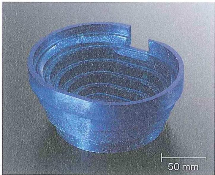
突き出しの長い工具で掘り込みを行った。産業機械用部品のサンプルワークである。
